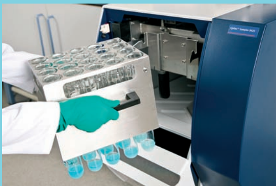
Semplicemente caricare il rack dei campioni direttamente dal blocco digestore e il Kjeltec™ eseguirà analisi accurate anche senza la presenza dell'operatore
