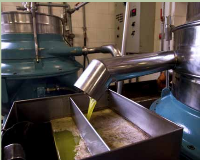
Controllo in produzione in un minuto: controllo della sansa per umidità ed olio
